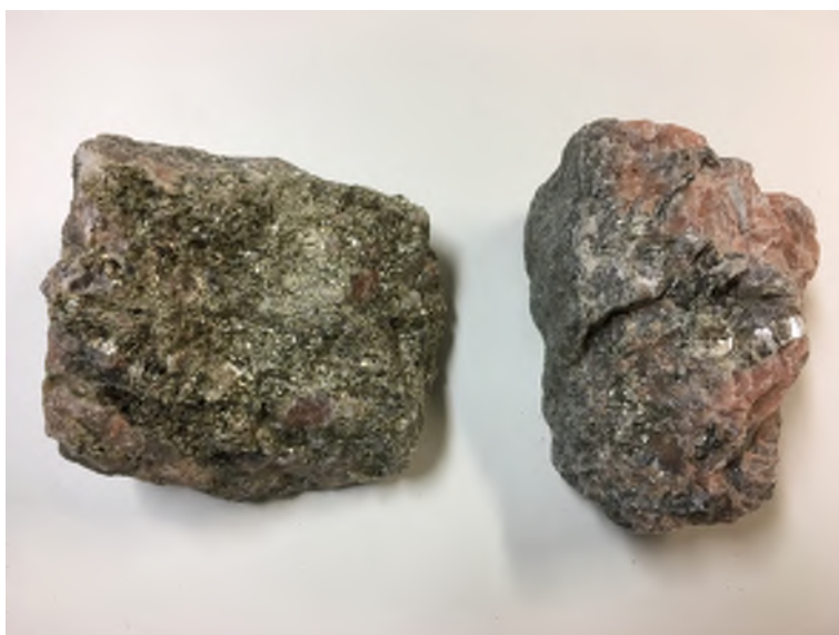
Figur 62. Levererat krossmaterial med hög glimmerhalt.
