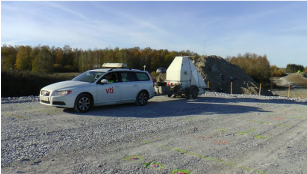
Figur 19. Mätning med tung fallviktsapparat.
