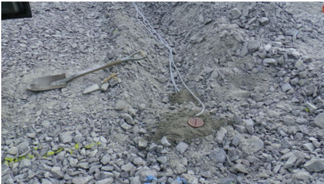
Figur 16. Färdiginstallerad stapel av EMU-spolar. På bilden syns endast den översta spolen.
