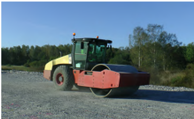
Figur 4. Dynapac CA6500D med frekvensstyrning.
