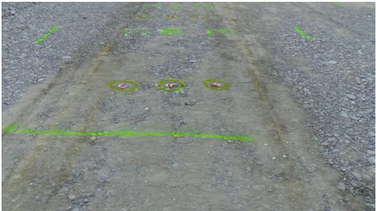
Figur 3. Glimmerrikt och sönderfallet material efter packning.
